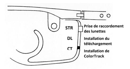
Sous la prise de raccordement des lunettes se trouve un commutateur permettant d'accéder à deux programmes :
